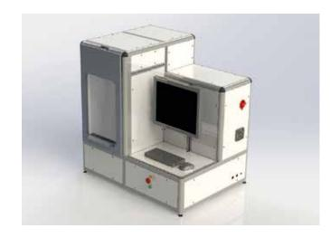
O Medidor semiautomático de ruptura de aerossol B303 foi desenvolvido para verificar se os aerossóis da produção atendem aos requisitos mínimos de pressões de deformação e ruptura.
