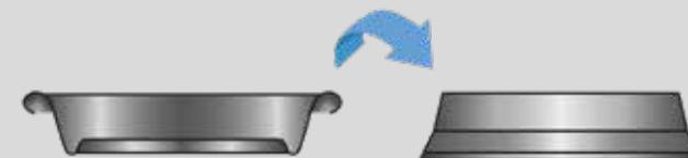
Uma vez “desenroscadas”, las carcasas son inspeccionadas por hasta 5 cámaras de alta resolución mientras giran 360 grados.
