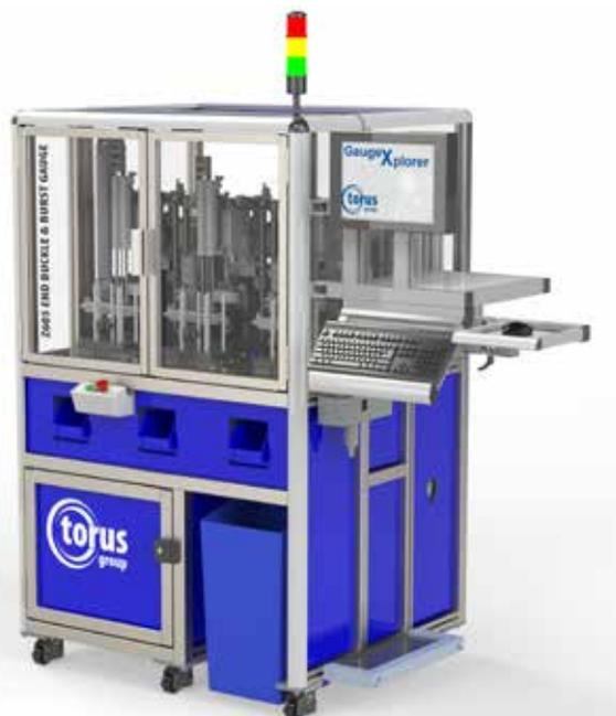
O novo modelo Z605 oferece aos nossos clientes a capacidade de realizar testes de deformação e ruptura de extremidade sem a necessidade de trocar peças.
