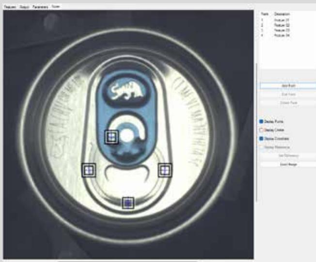
Basta configurar as posições de medição usando uma interface de arrastar e soltar em uma imagem da extremidade a ser medida.
