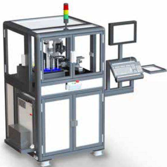
**O Medidor automático de vinco Z606 foi desenvolvido para fornecer a mais alta precisão, repetibilidade e usabilidade para a medição de vinco residual tanto na extremidade de alimento quanto na de bebida.**
